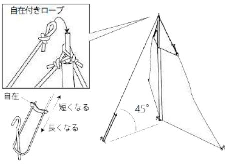
自在付きロープをメインポールの先端に取り付けて、上図のようにベグダウンして本体を立ち上げます。
