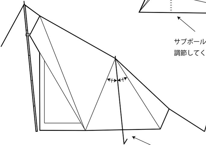
サブポールの自在付きロープは、側面の3角のパネルを均等に分割する角度でペグダウンしてください。
