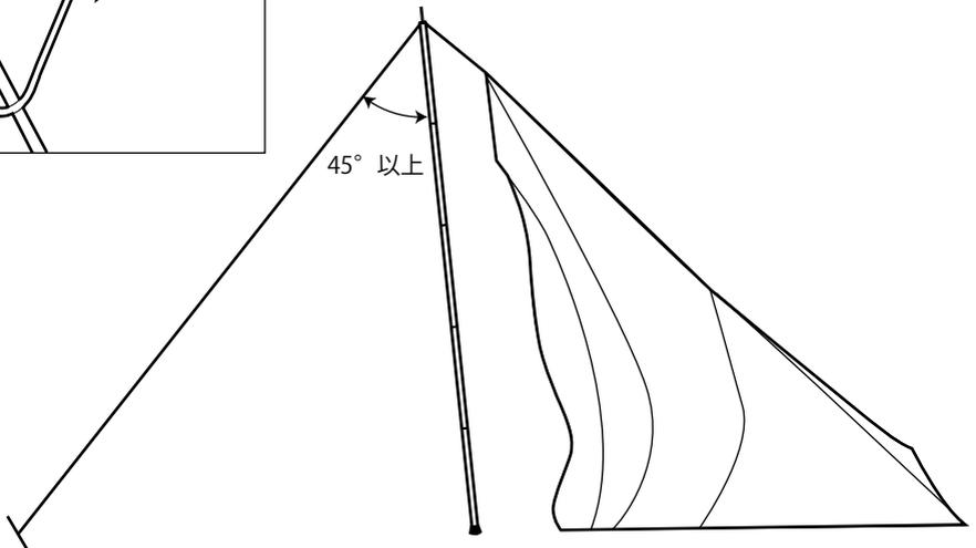
⑥サブポールを組み立てます。ポールは各接続部にすき間が無いように注意してください。テント内にサブポールをもぐりこませ、先端をグロメット（穴）から出し、先端にエンドキャップを嵌めてから自在付きロープ（長）でペグダウンします。ロープのペグダウン位置は、「設営のポイント」を参照してください。
