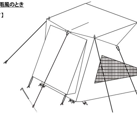
オーバーフラップを開め、側面三角部をベグダウンして固定した上で、雨落としをカラビナ付きロープ(グレー)使用し、ベグダウンして固定します
