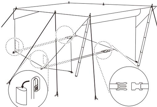
前後2箇所あるスタンディングロープのバックルを外し、テープは丸めてテープポケットに収納します。撤収前には再度バックルを装着して撤収すると次回設営がスムーズになります。
