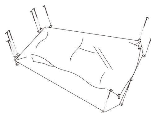
コーナリングとフロント・リアリングで地面と固定していたベグを全て引き抜き、本体を畳める状態にします
