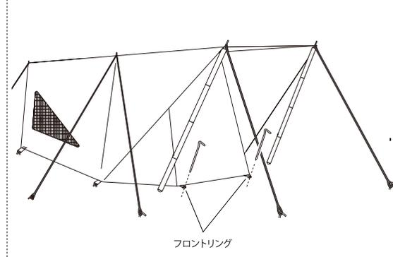
フロントドア下部のフロントリング2箇所をベグダウンして、地面と固定します
