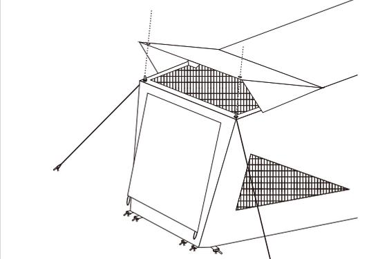
オーバーフラップ先端のグロメットをリアポール先端に差し込み、オーバーラップを固定します
