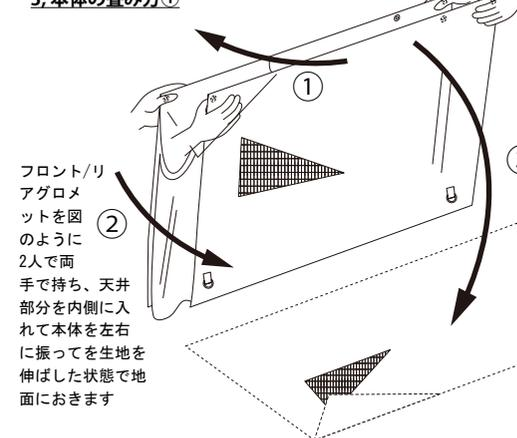
フロント/リアグロメットを図のように2人で両手で持ち、天井部分を内側に入れて本体を左右に振って生地を伸ばした状態で地面におきます
