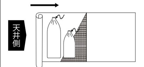
④天井側から空気を抜きながらポールケース・ベグケースと一緒に巻いていき、収納袋に収納します
