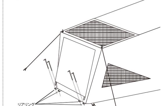
リアドア下部のリアリング4箇所をベグダウンし、地面と固定します
