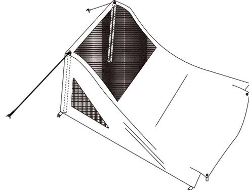
反対側も同様にリアポールを本体と地面の間から内側に入れ、リアグロメットに差し込み、自在付きロープ(黒)を使用しベグダウンします
