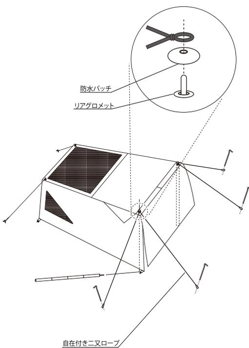
フロントポールをリア同様、本体と地面の間から潜り込ませ、フロントグロメットに差し込み、防水パッチを装着したあと、自在付き二又ロープを使用してベグダウンします
