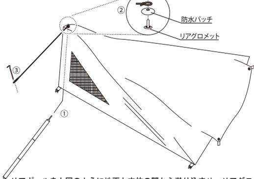
リアポールを上図のように地面と本体の間から潜り込ませ、リアグロメットに差し込み、防水パッチを装着したあと、自在付きロープ(黒)を使用してベグダウンします
